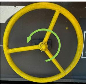
Der Wagen darf nur mit gelöster Handbremse bewegt werden.
