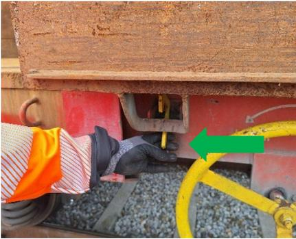
Die Sicherungsfalle anheben und die Türflügel schließen.
