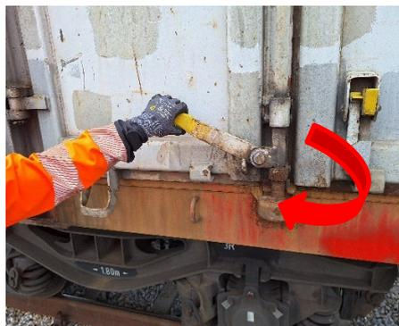
Die Sicherungsfalle des Verschlusshebels entriegeln.
