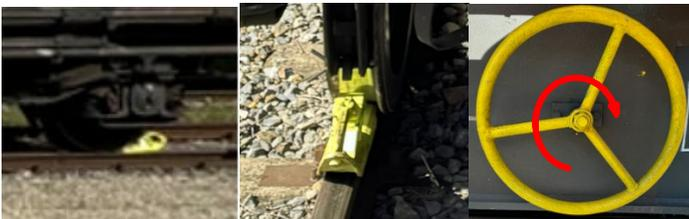
Vor jeder Be- und Entladung ist das Fahrzeug durch Anziehen der Handbremse und oder anderwärtigen Sicherungsmittel (Hemmschuhe) zu sichern.
