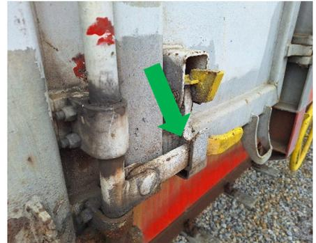
Den Betätigungshebel bis zum Endanschlag bewegen und mittels Sicherungsfalle sichern.
