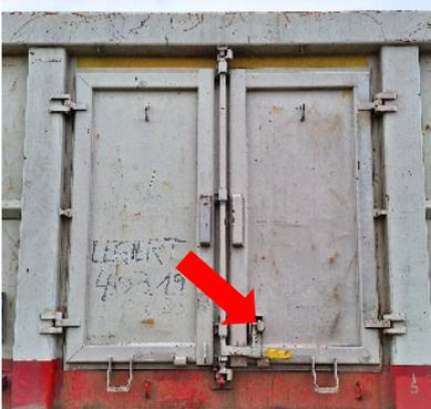
Die Betätigung zum Öffnen und Schließen, befindet sich direkt an den Türen des Wagens.
