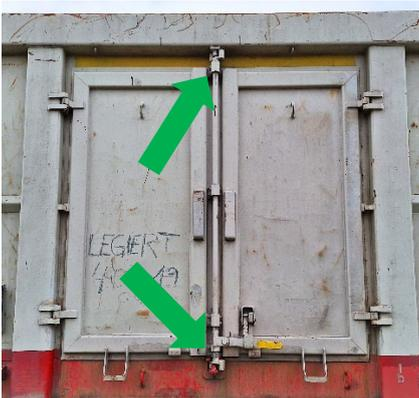
Nach dem Schließen der Türen ist sicherzustellen, dass beide Verriegelungsklauen ordnungsgemäß verriegelt sind.
