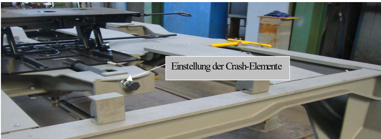
Stützbock mit Crash-Elementen
