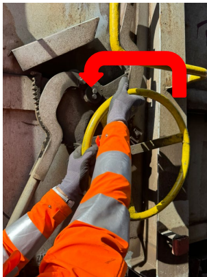
Verschlussrad bis zur Endposition nach links drehen
