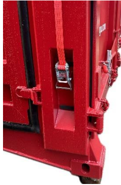
Abbildung 2 - Ratsche 1/5 bei seitlichen Türen
