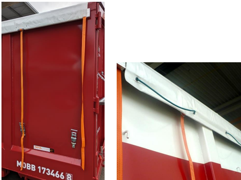
Abbildung 9 - gelöste Spannmittel, Zurrgurte (links) und Expanderschnüre (rechts)
