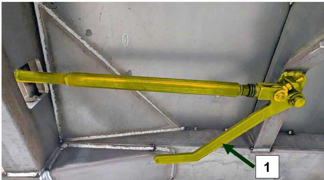
Abbildung 3 – Übertotpunktspanner der Zentralverriegelung
