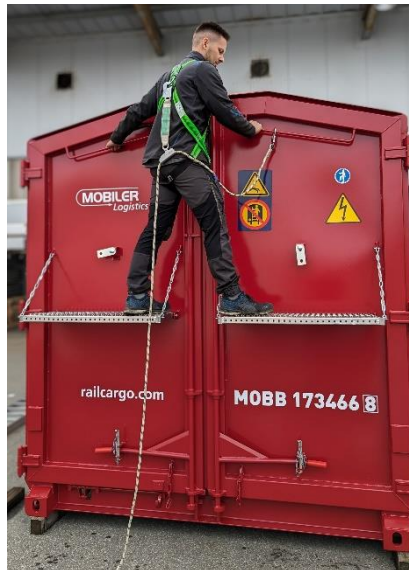
Abbildung 14 - Absicherung beim Betreten der Podeste
