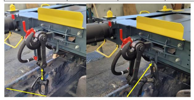
1 = Schraubenkupplung über Schienenoberkannte
